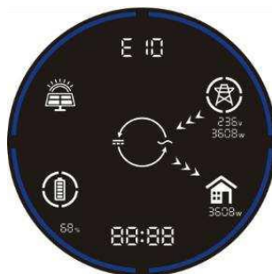
Figure 2.5.3-4 Visualizzazione guasto su display
